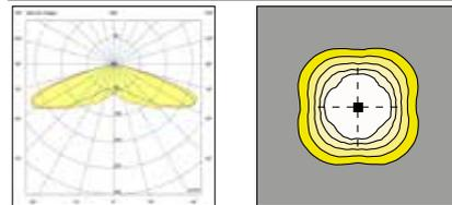
Les données photométriques nominales se réfèrent uniquement aux sources LED en version standard, c'est-à-dire avec une température de couleur de 4000 K, un indice de rendu des couleurs CRI 70 min. et une température de jonction  $t_j$  égale à 25°C. Les données nominales sont extrapolées à partir de la fiche technique du fabricant.
