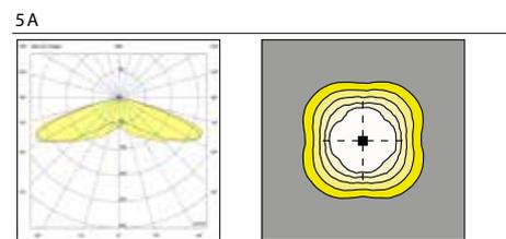
Les données photométriques nominales se réfèrent uniquement aux sources LED en version standard, c'est-à-dire avec une température de couleur de 4000 K, un indice de rendu des couleurs CRI 70 min. et une température de jonction  $t_j$  égale à 25°C. Les données nominales sont extrapolées à partir de la fiche technique du fabricant.
