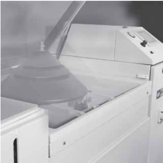
Test en brouillard salin La haute qualité de ces traitements est confirmée par un test en brouillard salin, réalisé conformément à la norme ISO 9227:2017 Test de brouillard salin neutre (NSS). Le test a été effectué pendant 8000 heures à 35°C et a été prouvé par le rapport d'essai publié.
