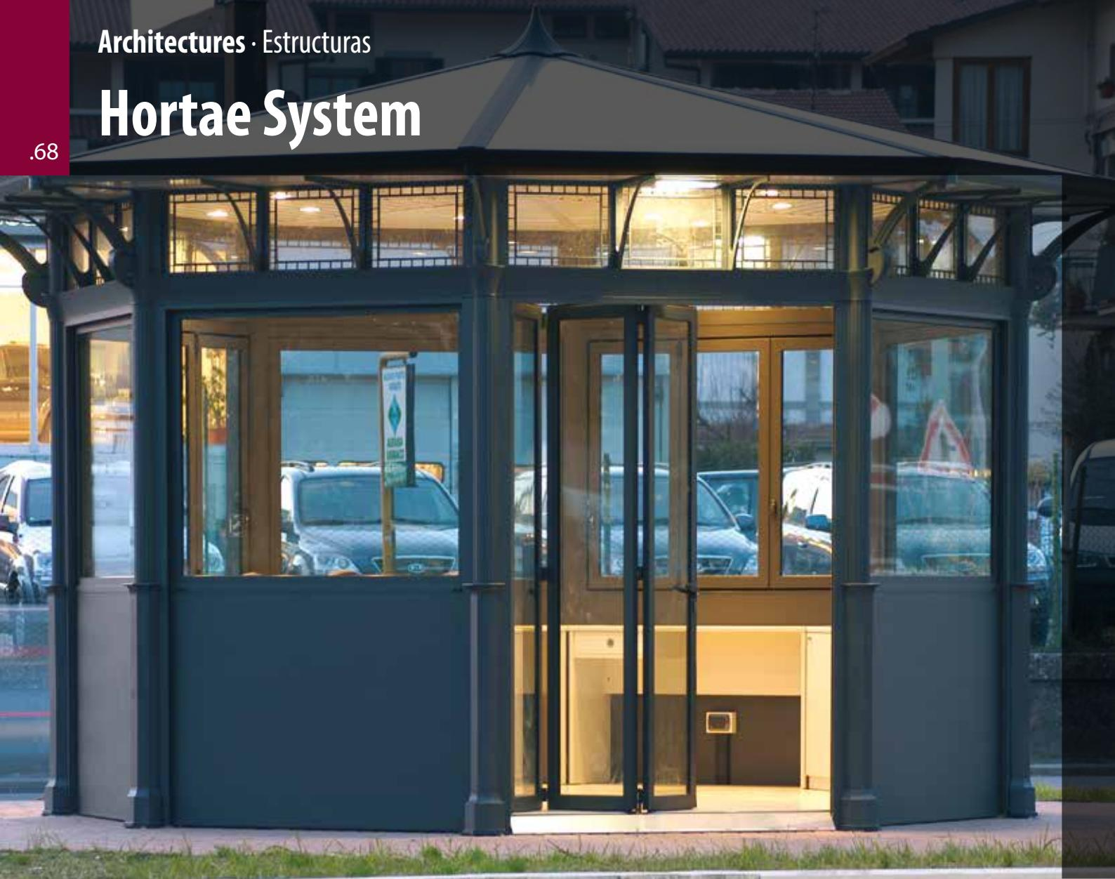
**Système de kiosque conçu pour s'intégrer dans des environnements urbains prestigieux tels que les centres historiques et les parcs de la ville. Nos kiosques s'assemblent complètement sans besoin de ciment. Structure portante composée de colonnes en acier galvanisé. Cadres, murs, fenêtres et finitions en aluminium extrudé disponibles en différents types. Panneaux en tôle d'aluminium avec matériau isolant interposé, pièces en verre incassable. Éléments décoratifs en fonte d'aluminium.**
